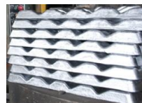
棒状のアルミインゴットを溶解します
